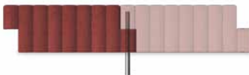
Einfache Verbindung mit Montagerohren und Bodenanker easy connection with mounting tubes and ground anchor
