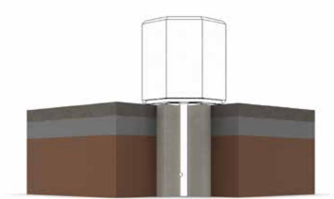
Einfundamentierung des Terrasoft Polygons mit Hilfe des Bodenankers.
