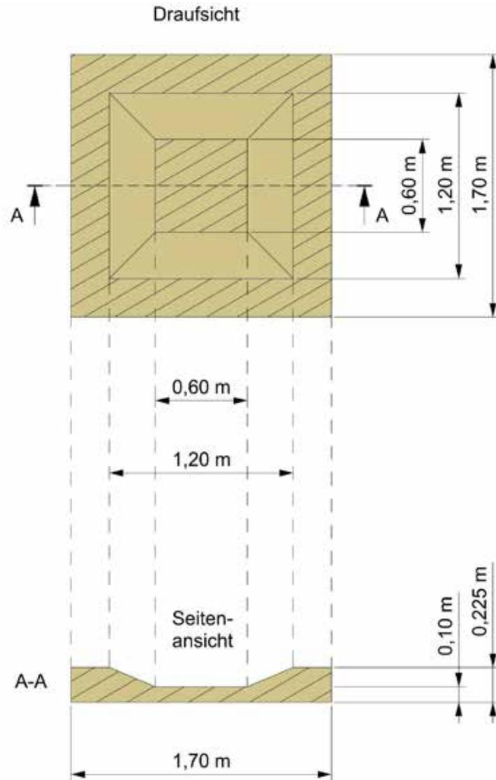
Skizze 2: Sickerschicht aus KFT-Material
