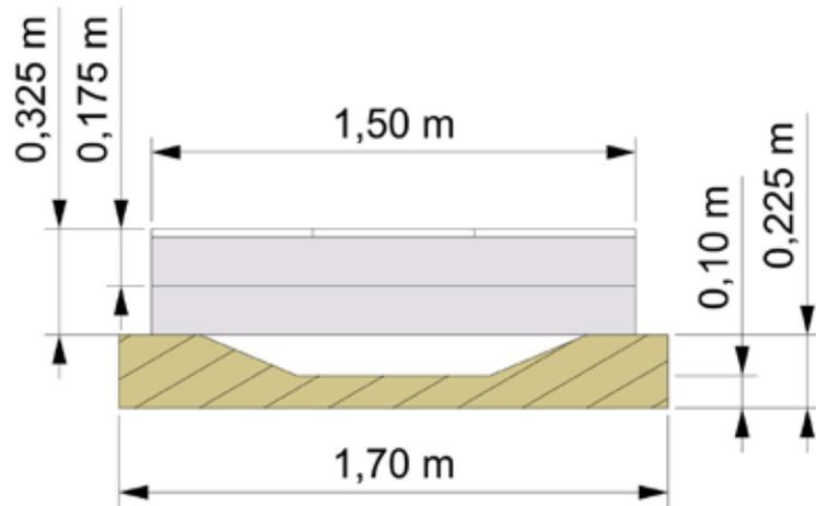
Skizze 3: Schnitt des eingebauten Sprunggeräts
