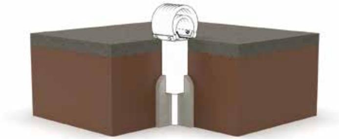
Der Terrasoft Wippendämpfer wird in einem kleinen Betonfundament fixiert.
