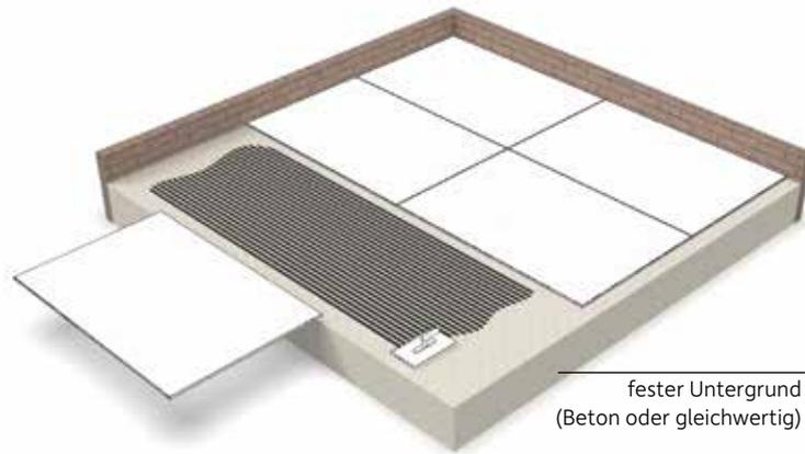
Verlegung auf ebenem, festem Untergrund. Mit Hilfe einer Zahnpachtel wird die Terrasoft Flächenverklebung auf dem vorbereiteten Untergrund aufgebracht.
