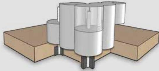
Einfundamentierung des Kettenelements mit Hilfe von verlängerten Montagerohren auf losem Untergrund.
