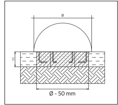
Einfundamentierung der Terrasoft Halbkugel mit Hilfe des Bodenankers. Das Fundament ist 50 mm kleiner als der Durchmesser der Halbkugel.
