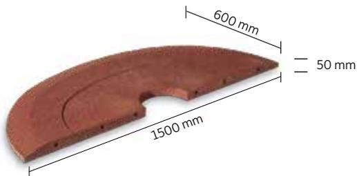
Die nachträgliche Abdeckung der Aufprallfläche von Klein- und Federspielgeräten ist mit den Terrasoft Federwippeinfassungen problemlos möglich. Die beiden Einfassungshälften werden über Systemstecker (Durchmesser 15 mm) verbunden und fixiert, um Sauberkeit im Bereich der Bodenbefestigungen zu gewährleisten.
