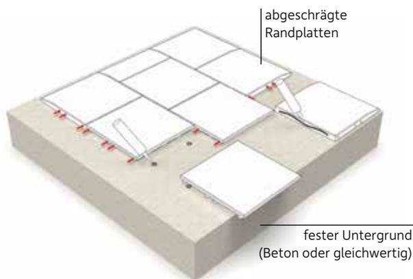
Verlegung (Halbverband) auf ebenem, festem Untergrund mit abgeschrägten Randplatten & Systemsteckern.
